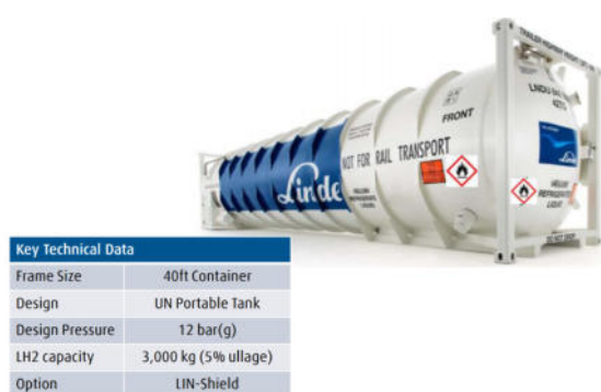
Fig. 5.16 : Hylics UN portable LH 2 tank (Linde®)
